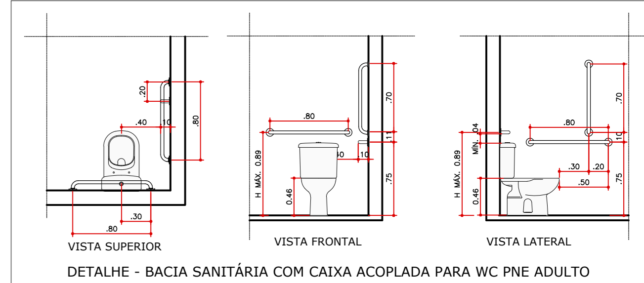
DETALHE - BACIA SANITÁRIA COM CAIXA ACOPLADA PARA WC PNE ADULTO
